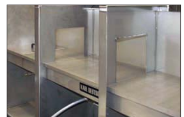
Sonderprüfplatz mit Tauchbecken und Durchreiche
